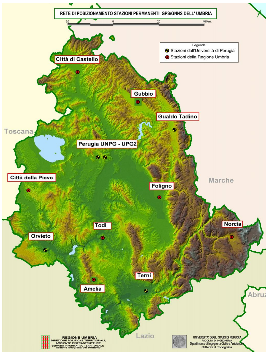
Fig. 12 – La rete GNSS permanente umbra, denominata GPSUMBRIA, istituita nel 2006 da Regione Umbria e Università degli Studi di Perugia e potenziata nel 2009 con due nuove stazioni e servizi in tempo reale
