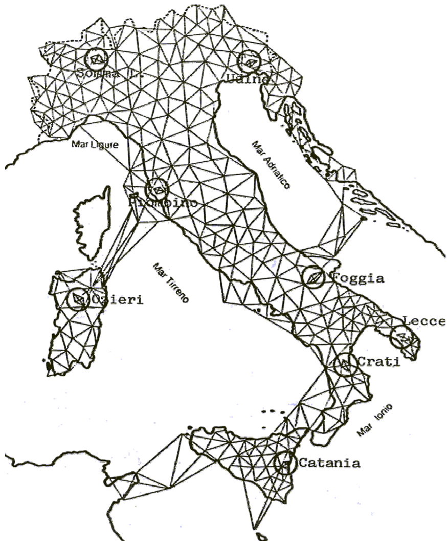
Fig. 2 – La rete geodetica fondamentale (I ordine) dell'IGM nella sua conformazione originaria (ca. 1910). Sono evidenziate le 8 basi (lunghezze) misurate e le relative reti di sviluppo. Tutte le altre misure erano costituite da angoli. I collegamenti con la Sardegna, di eccezionale lunghezza (quasi 150 km), vennero eseguiti di notte con potenti proiettori fotoelettrici [da Tonini]
