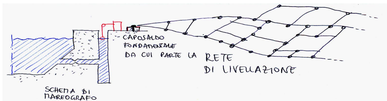
Fig. 16 – Schema di mareografo, caposaldo fondamentale e rete di livellazione
