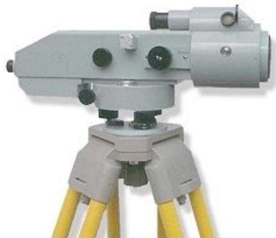
Zeiss Ni-1 : Autolivello per livellazioni di alta precisione con micrometro a lamina pianparallela Sensibilità di lettura 1/100 di mm
